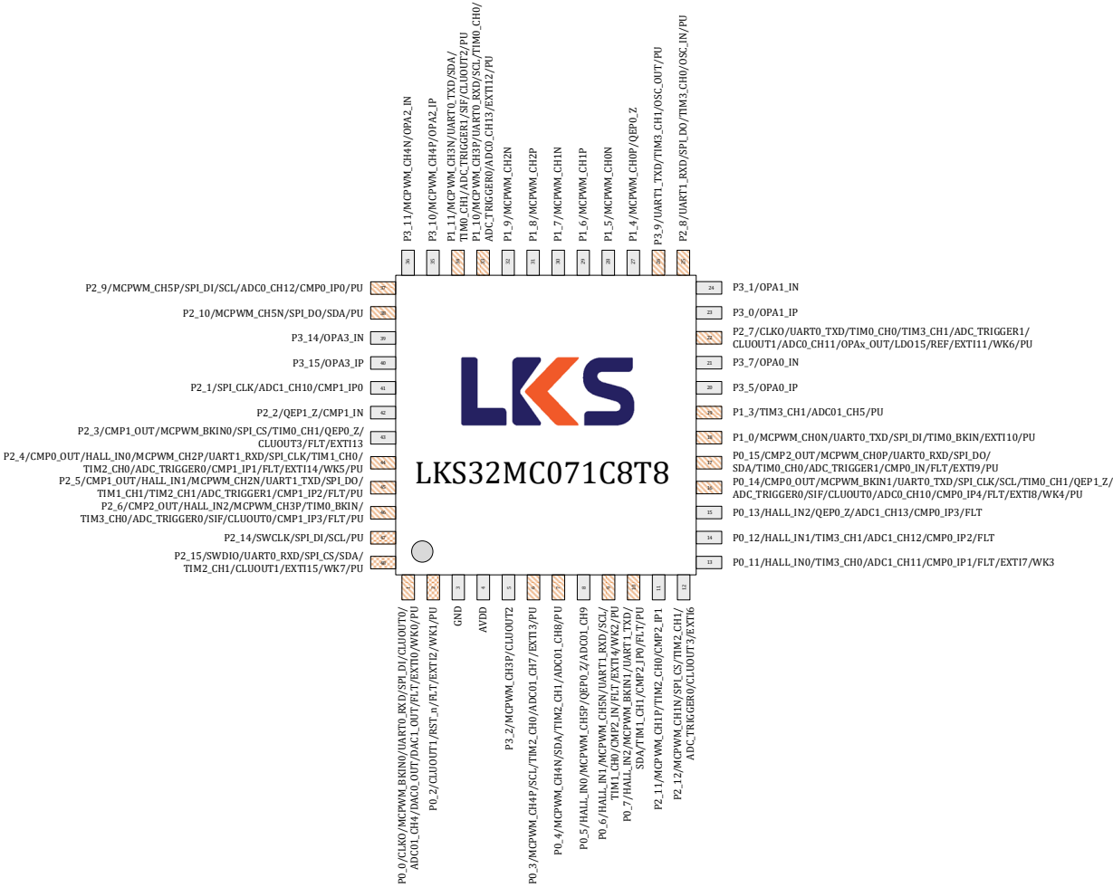
图 3-2 LKS32MC071C8T8 管脚分布图
