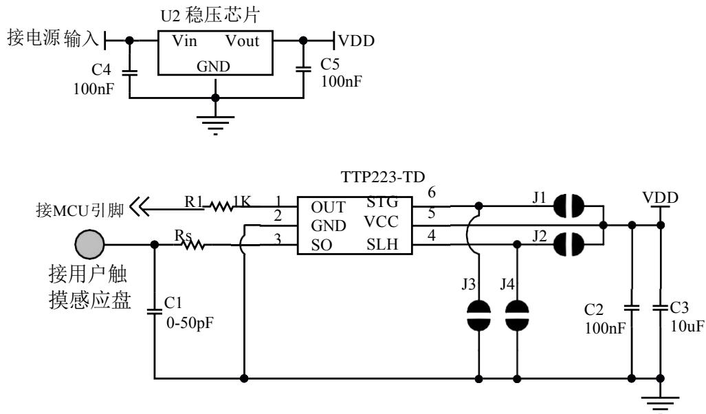
注 1: C1 电容值越大, 灵敏度越低, 感应面板的厚度就越薄。
