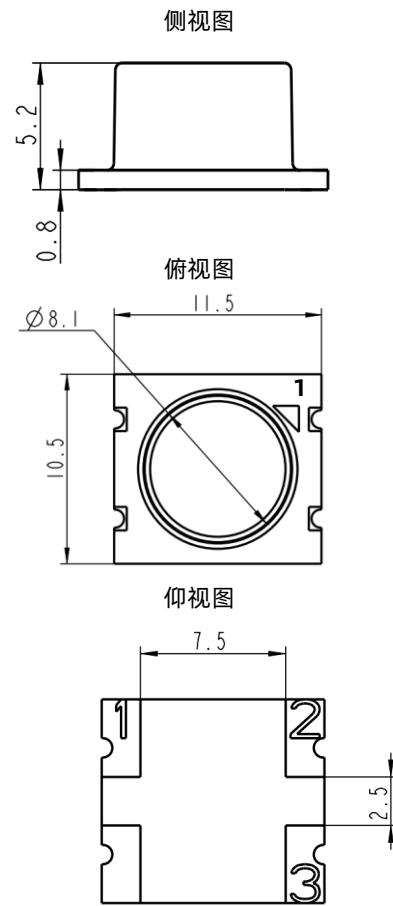
传感器主要由催化元件（黑元件）和补偿元件（白元件）组成，黑、白两个元件被安装到电桥中，通过可变电阻可调整电桥输出稳定的基准信号。当环境中存在氢气气体时，在催化元件表面会发生燃烧，元件表面温度上升，导致元件电阻增加，电桥失衡，通过电路采集电桥的输出电压。
