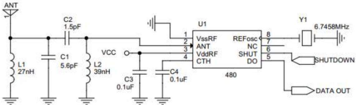
图2 433.92MHz 1.5kbps典型电路
