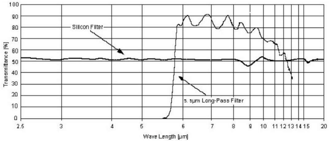
注意：图表所示为典型的 5μ m 红外滤光片参考图，曲线是红外线通过率的平均值。该窗口材料是经过特殊真空镀膜处理过的半导体硅片。
