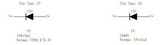
顺向电压 VF 过高或反向电压 VR 过高,均会损坏 LED。
