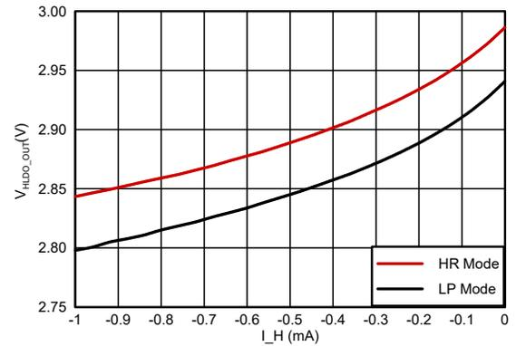
图 6-19. HLDO 输出电压与负载电流间的关系
