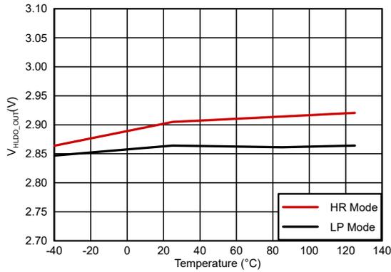
图 6-18. HLDO 输出电压与温度间的关系
