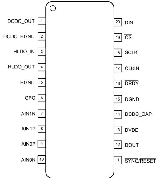
图 5-1. DFM 封装、20 引脚 SOIC (顶视图)
