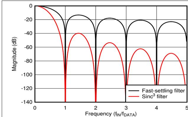
图 8-7. 快速稳定和  $\text{Sinc}^3$  数字滤波器响应
