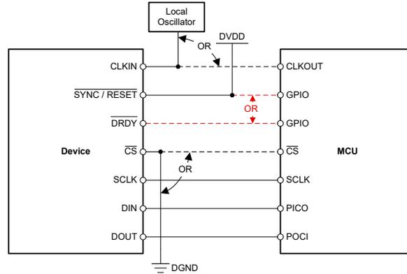
图 9-2. 所需的最小连接数 - 用于运行 AMC130M02
