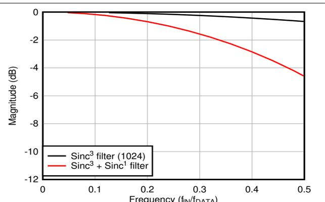
图 8-10. OSR = 4096 时的  $\text{Sinc}^3 + \text{Sinc}^1$  数字滤波器响应，通带详细信息
