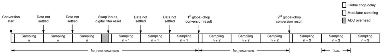
图 8-21. 启用全局斩波模式时的转换时序
