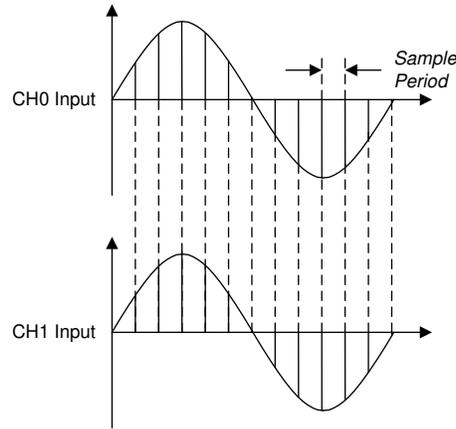
图 8-11. 两个具有相同相位设置的通道输出
