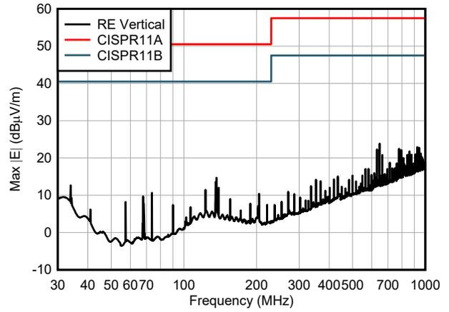
图 9-7. AMC130M02 垂直辐射发射 CISPR11 测量
