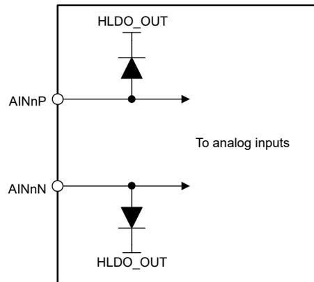
图 8-3. 输入 ESD 保护电路
