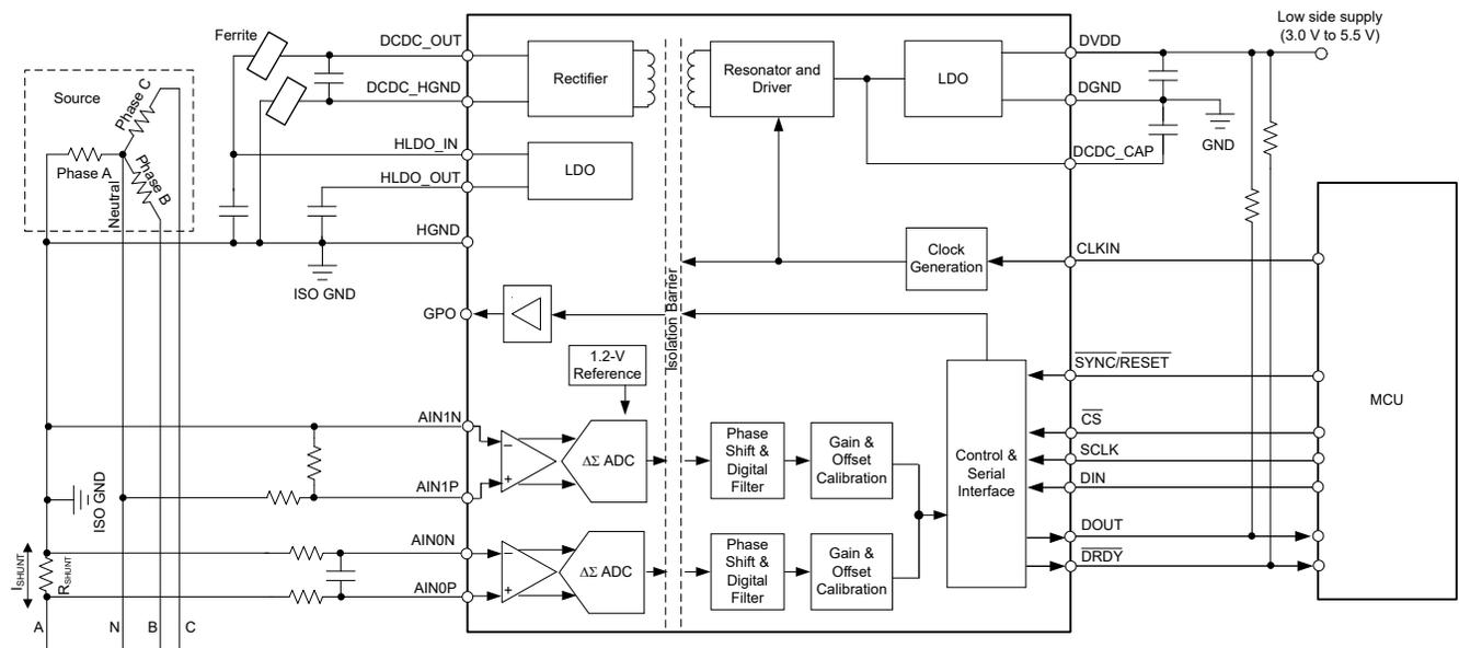
图 9-5. 电流和电压检测 - 使用 AMC130M02
