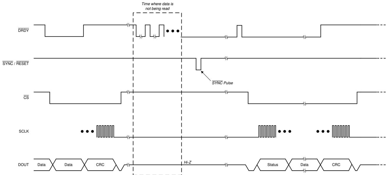
图 8-29. 使用 SYNC/RESET 引脚在暂停后收集数据
