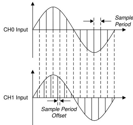
图 8-12. 相对于通道 0 具有正样本相移的通道 1
