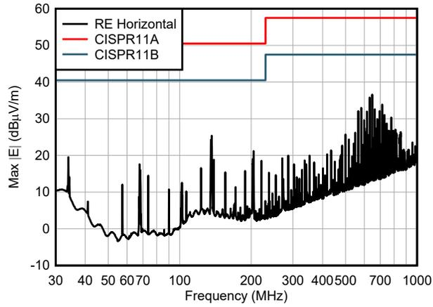
图 9-6. AMC130M02 水平辐射发射 CISPR11 测量
