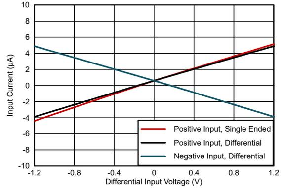
图 6-7. 输入电流与差分输入电压间的关系
