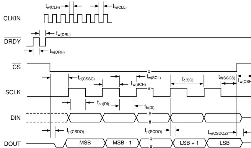
SPI 设置为 CPOL = 0 且 CPHA = 1。CS 转换必须在 SCLK 为低电平时发生。
