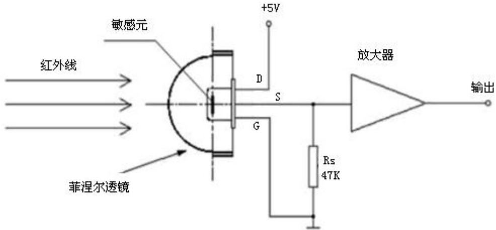
使用菲涅尔透镜可决定传感器的检测范围和检测距离。根据客户的要求，可以对应各种检测范围和检测距离。
