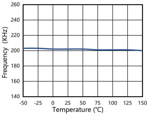
图 7 频率(CLK 悬空) vs 环境温度
