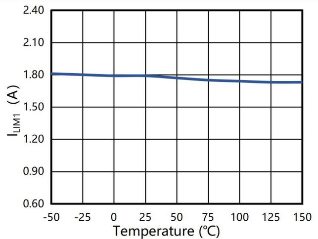
图 12 钳位电流 vs 环境温度
