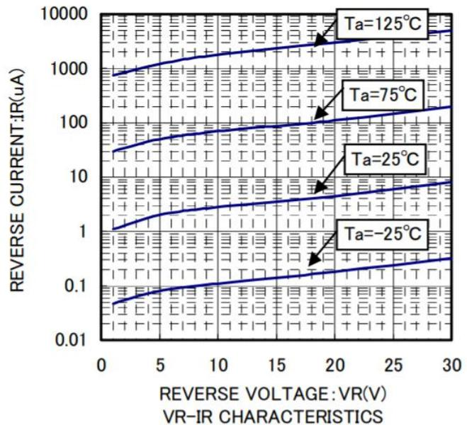
图 9.3 肖特基二极管 RB160M-30 工作特性曲线
