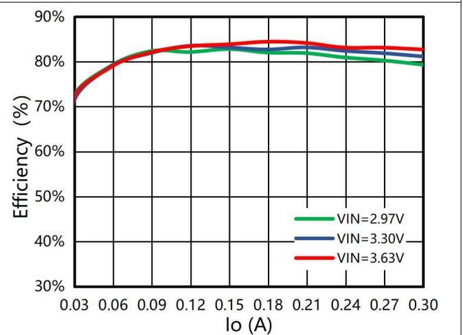
图4 转换效率 vs 输出电流
