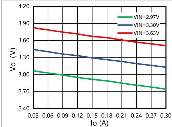
图3 输出电压 vs 输出电流
