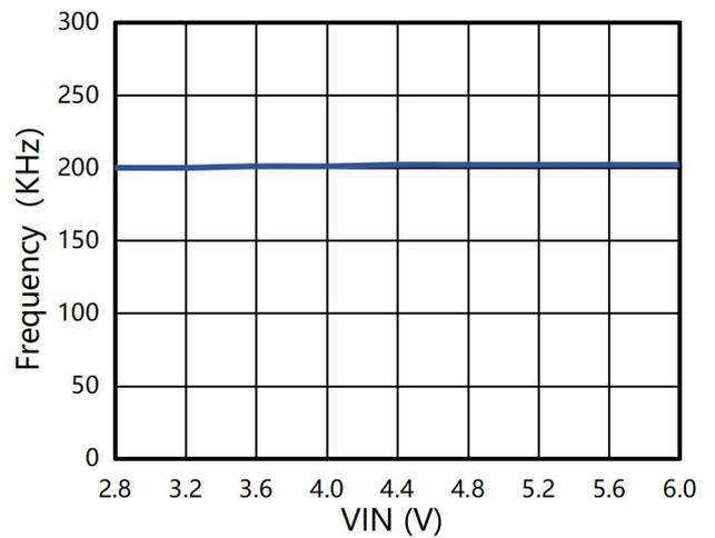
图 10 频率(CLK 悬空) vs 输入电压
