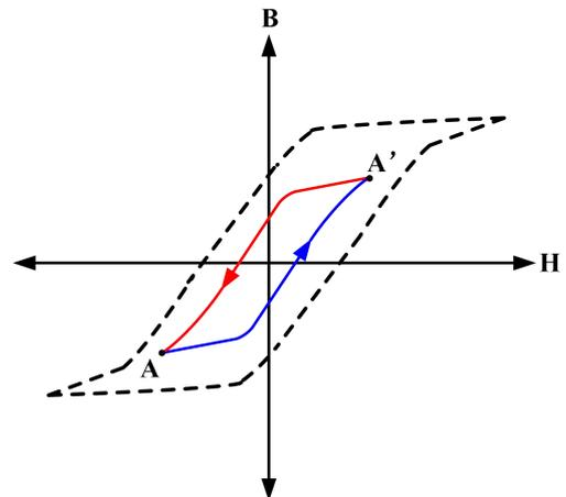
图 8.4.3 推挽变压器磁芯磁化曲线
