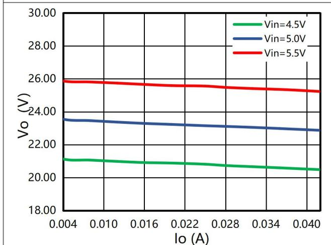
图5 输出电压 vs 输出电流
