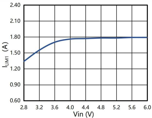
图 11 钳位电流 vs 输入电压
