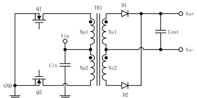
图 8.4.1 推挽变换器电路原理图
