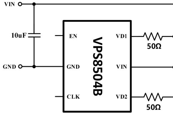
图 7.1  $f_{sw0}$  \  $V_{SLEW}$  \  $t_{BBM}$  的测试电路
