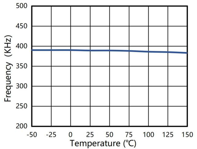
图 8 频率(CLK 接地) vs 环境温度
