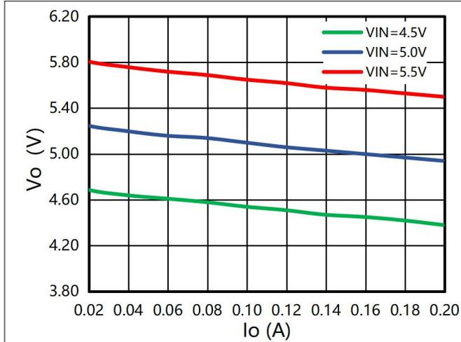
图1 输出电压 vs 输出电流
