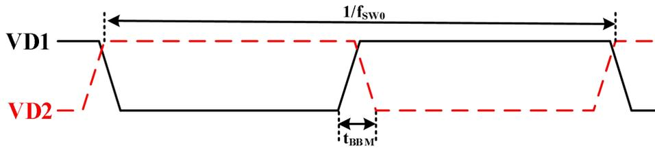
图 7.2 VD1 和 VD2 引脚电压时序图
