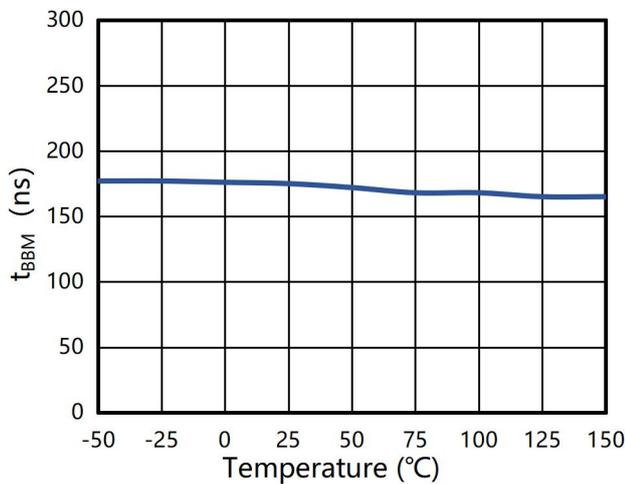
图 9 死区时间(CLK 悬空) vs 环境温度
