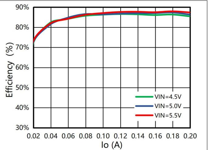
图2 转换效率 vs 输出电流
