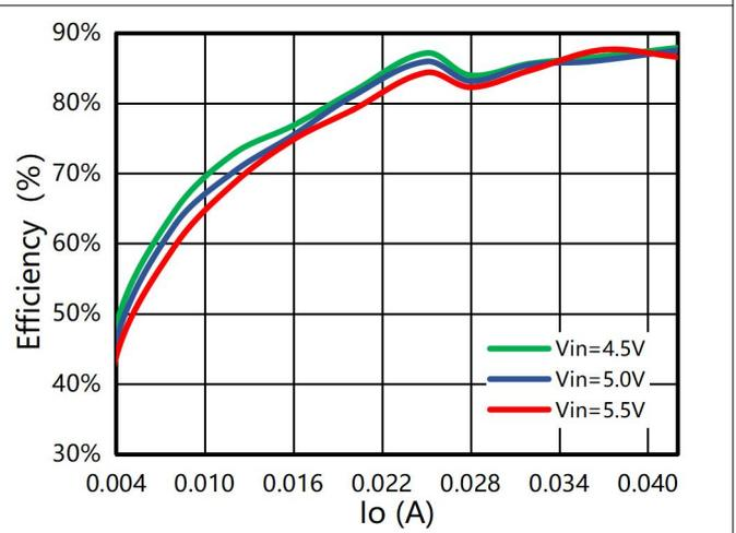
图6 转换效率 vs 输出电流
