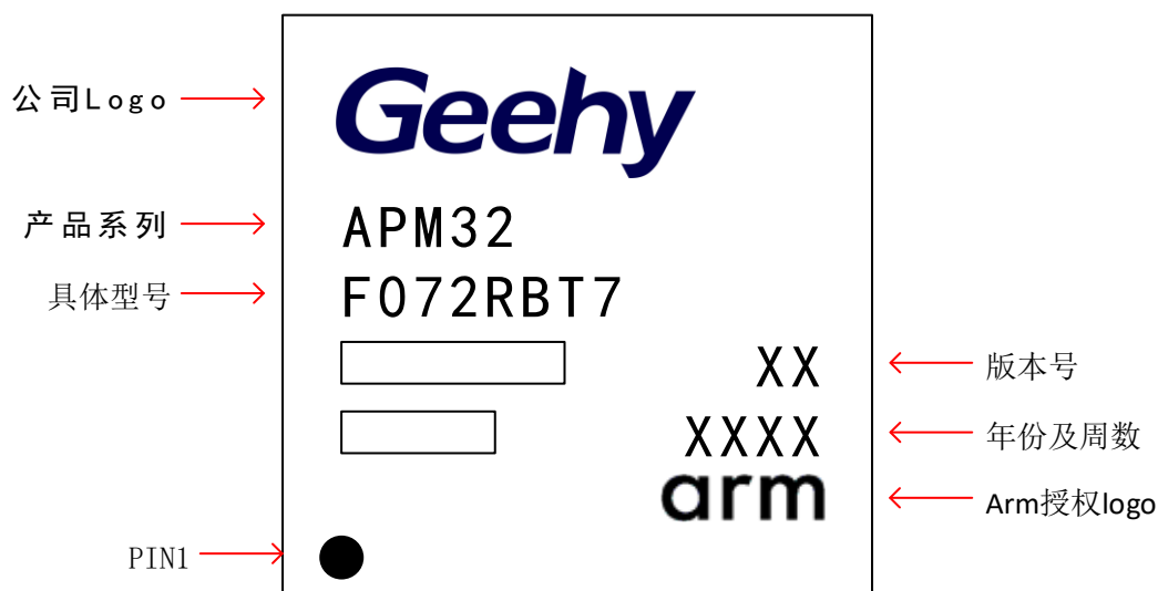
图 15 LQFP64 - 64 引脚，10 x 10mm 封装标识
