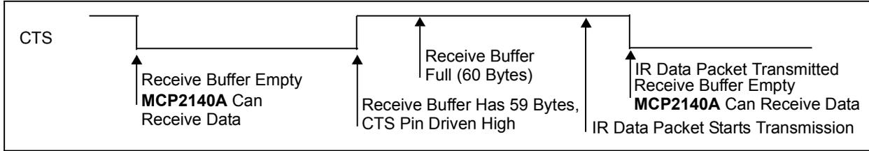
**FIGURE 2-4: CTS WAVEFORM FROM HOST CONTROLLER STREAMING OF 250 BYTES TO THE MCP2140A**
