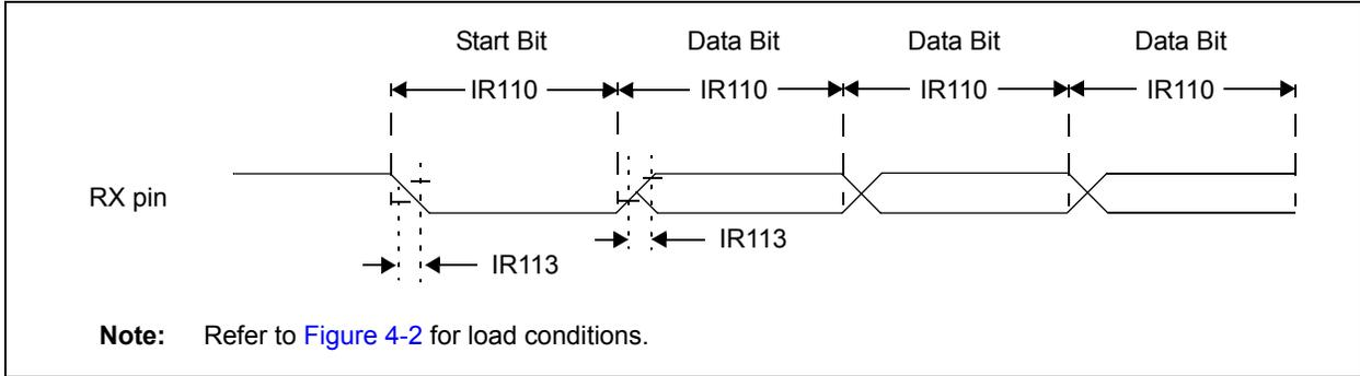
**TABLE 4-6: UART ASYNCHRONOUS RECEIVE REQUIREMENTS**
