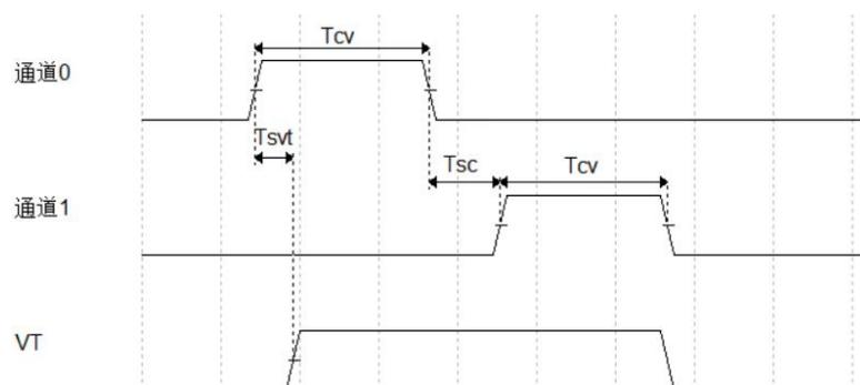
图 6.3.2-2 双通道单次转换模式工作时序图
