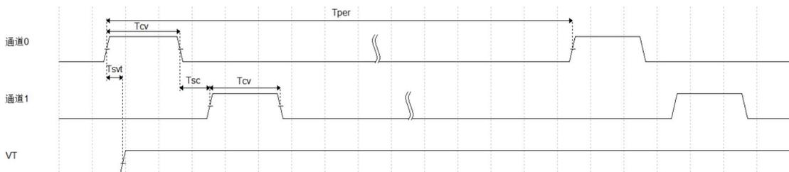
图 6.3.2-4 双通道连续转换模式工作时序图
