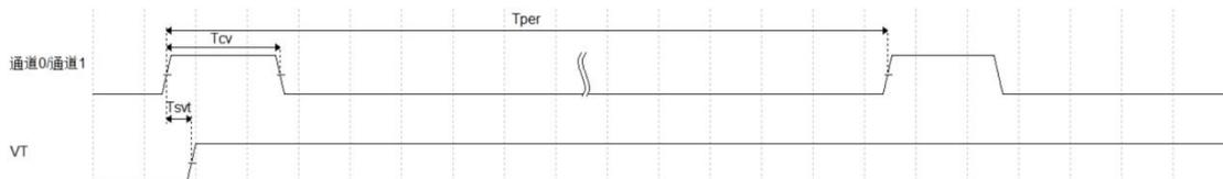
图 6.3.2-3 单通道连续转换模式工作时序图
