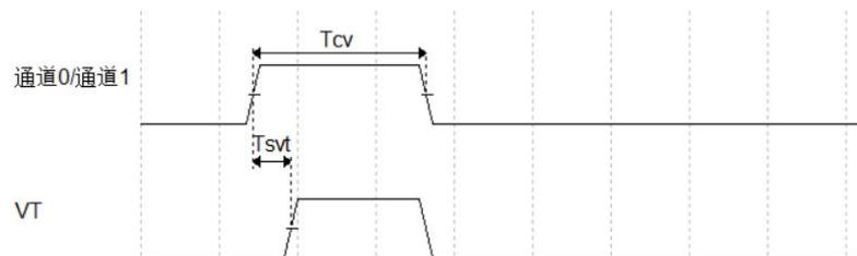
图 6.3.2-1 单通道单次转换模式工作时序图
