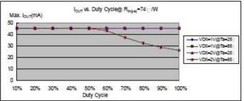
依据 PD(max)=(T.j-Ta)/Rth(j-a),被允许的最大散热功率会随环境温度增加而降低。
