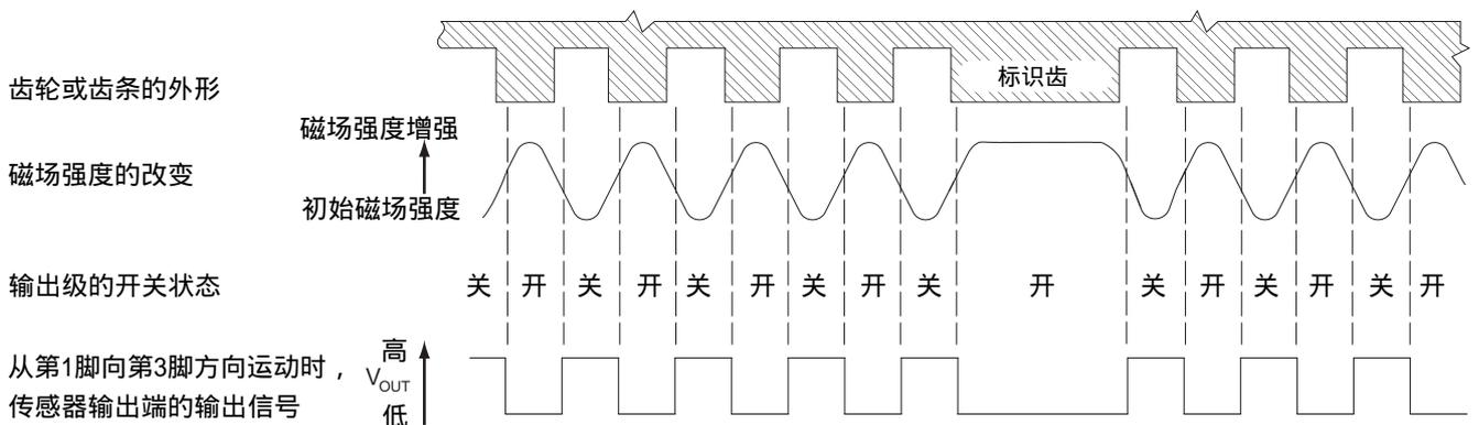
图 3，磁场的改变直接反映了检测目标的外部轮廓，在传感器的输出端输出了精确的数字信号响应
