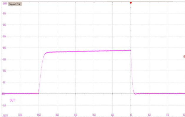
图 6-9 输出瞬态波形 (2000ns/Div)
