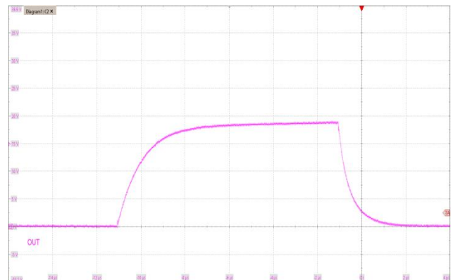
图 6-12 输出瞬态波形 (2000ns/Div)
