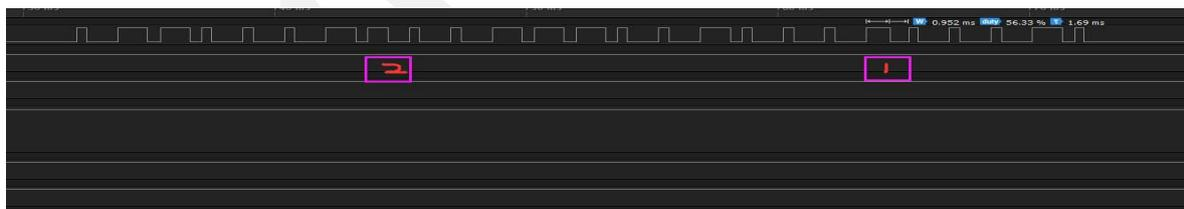
显然，1,2两处波形已经不是标准的1:3长度比，对比同一个键值正常的波形（下图）2处为变窄了，1处变宽了，这样就会将0和1解反：
