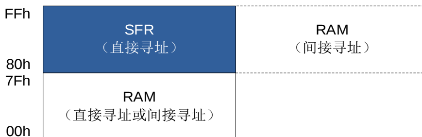
内部 256 bytes RAM 结构图
