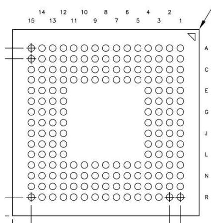
图 5-1. ZVB Package 176-Pin NFBGA Bottom View
