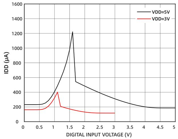
图 11 IDD 随输入电压的变化
