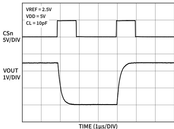
图 16 满量程高低电平转换
