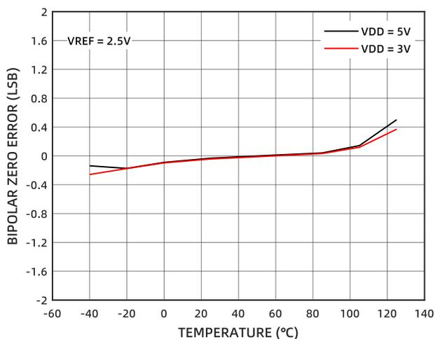
图 14 双极性零压失调误差的温度特性
