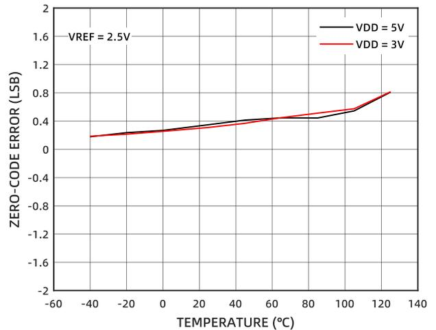
图 13 零码输入误差的温度特性
