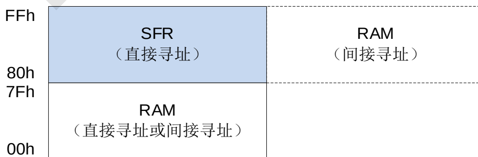
内部 256 bytes RAM 结构图
